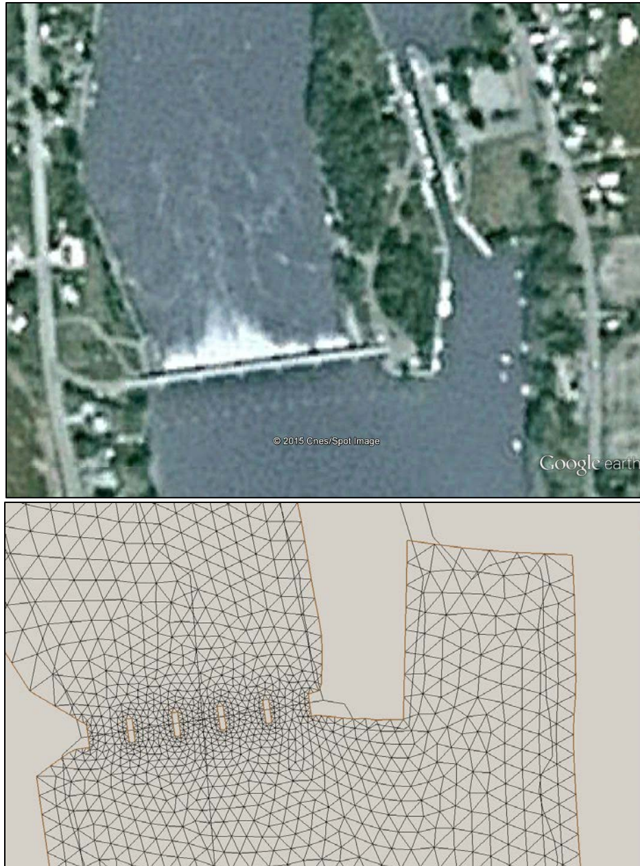
Figure 10 : Barrage de Saint-Ours et maillage correspondant
